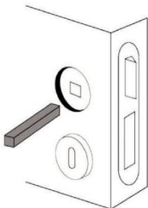
Posizionare la sottorosetta con il marchio **R** in basso. Fissare la sottorosetta con la vite in alto. Posizionare la maniglia in modo corretto regolare e avvitare accuratamente la sottorosetta con le viti in basso.
