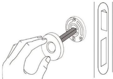
Inserire l'impugnatura sul quadro e fissarla serrando il grano con forza per incidere il ferro.
